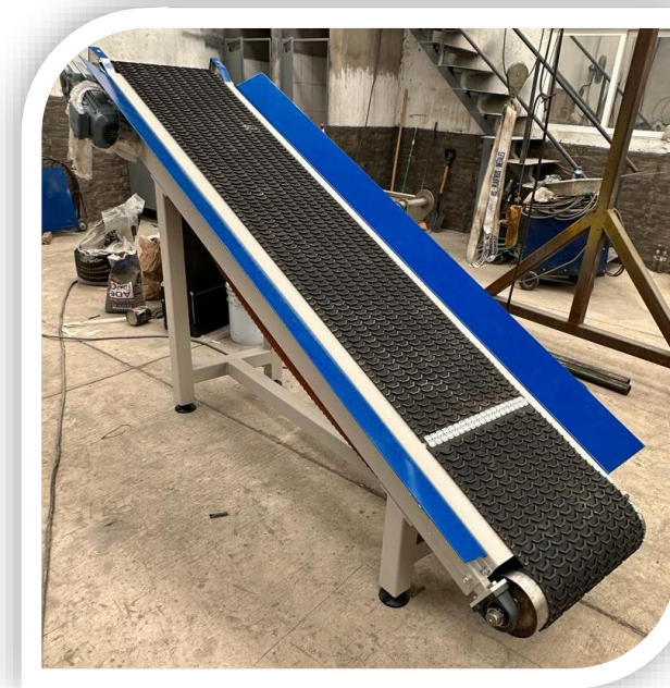
TRANSPORTADOR DE BANDA PARA COSTALES DE HARINA DE PESCADO
